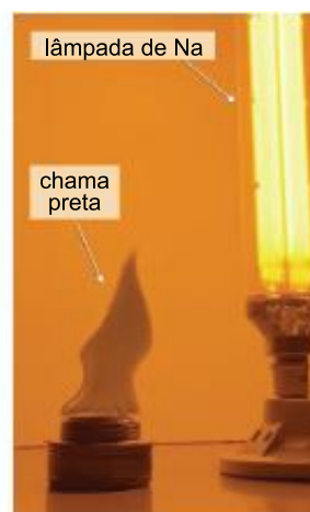
(II) Chama na presença de solução de \text{NaCl} , irradiada com lâmpada de Na.
